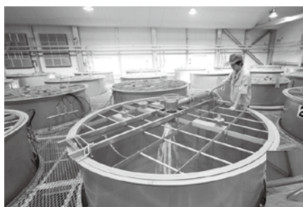
(上) 一次仕込み。麴と酵母、霧島裂罅水(れっかすい)を原料に「酒母(しゅぼ)」といわれる一次もろみをつくる (右) 二次仕込み。酒母に蒸したさつまいもと霧島裂罅水を加え発酵させる。この後、蒸留→熟成→ブレンド(調合)の工程をへて瓶詰めとなる
